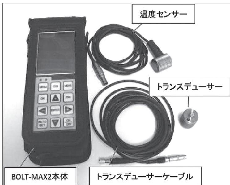
●超音波ボルト軸力測定計
