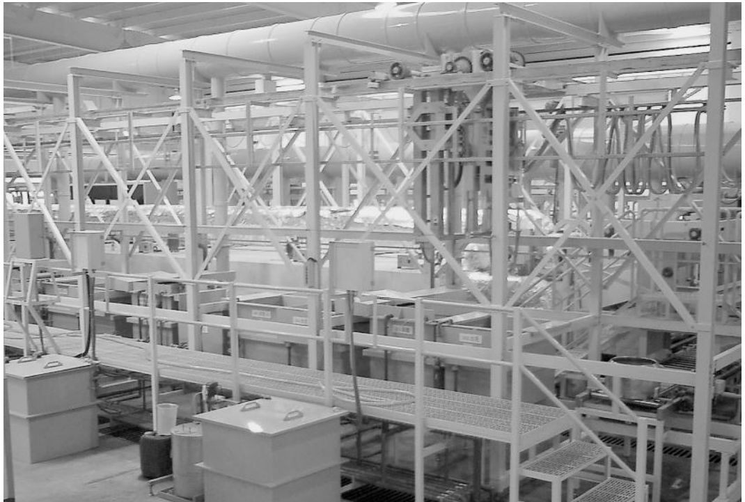
RoHS , E L V 指令を完全にクリアーした 3 価クロム化成皮膜処理ライン
