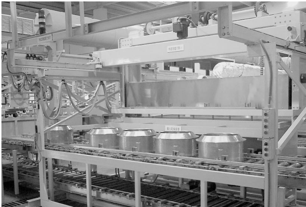
ベーキングライン。インラインベーキングにより水素脆性破壊，遅れ破壊の疑いを除去
