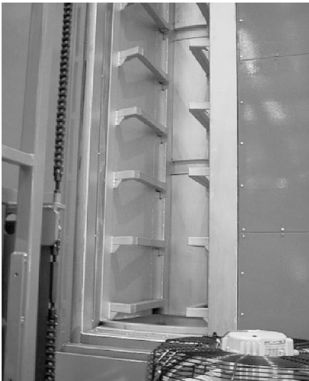
ベーキング炉の炉内の一部 水素脆性除去に威力を発揮する
