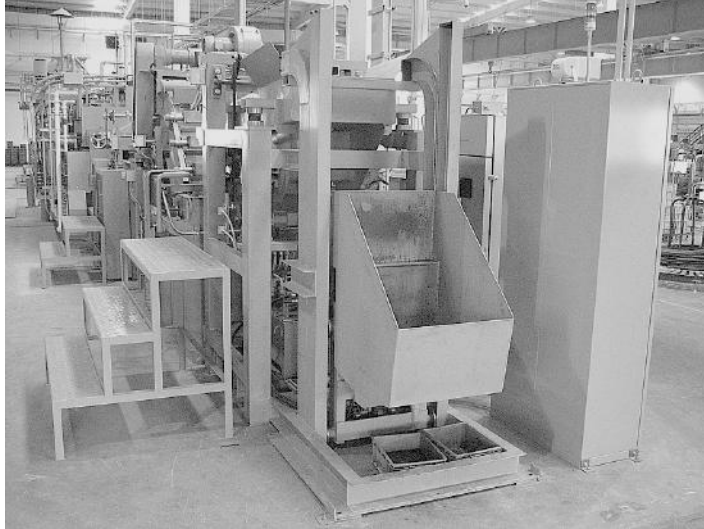
反転機 熱処理するワークを投入します。
