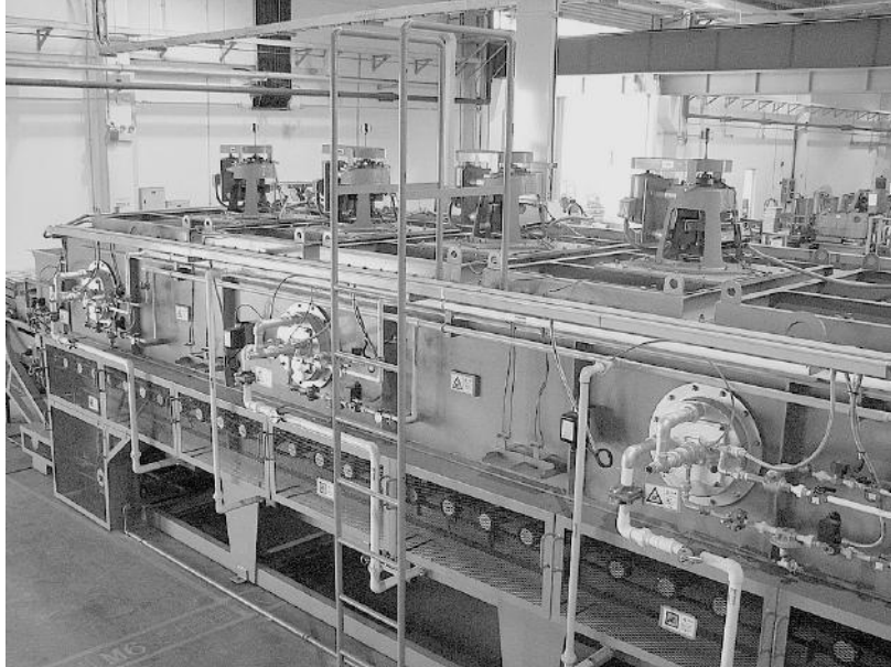
焼戻炉 ゾーンシステム及びファン配置による高品質の温度分布が得られます。
