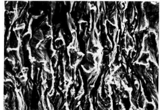
☆写真-5 仕上げ成型されたねじ頭部側面の自由R部分のSEM
