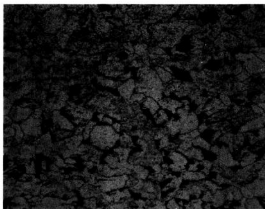
●写真 1・3 引張る前の状態 SWCH 12A・D
