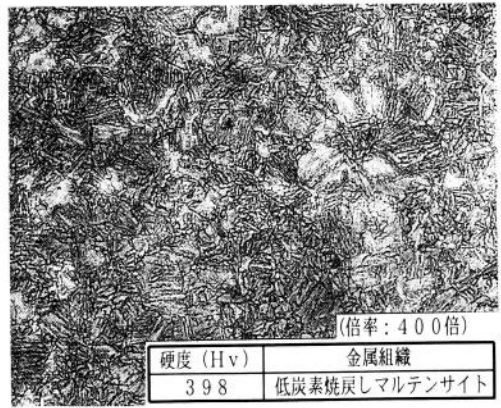
写真4 試験体C 心部の金属組織
