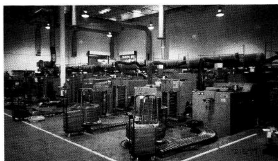
●IWATA BOLT USA INC. ロサンゼルス工場の圧造機ライン
