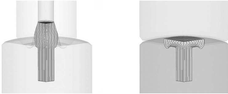
図3. 溶接ボルトのファイバーフロー
