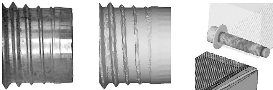
図4. APボルトの転造解析
