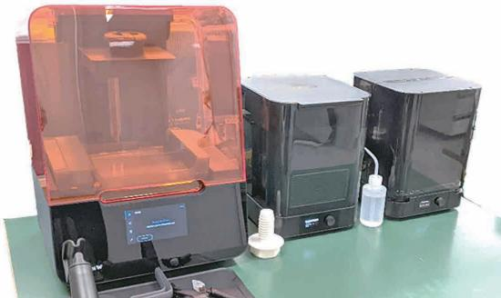
図 左から3D プリンタ本体、洗浄機、2次硬化機
