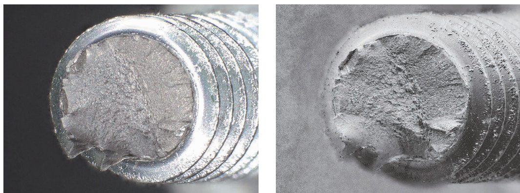
図3. 左側：通常の破面撮影 右側：Opt-SEM 機能を用いた破面撮影
